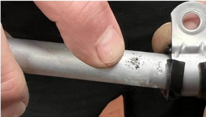
Die Leitungen sind aus blankem Aluminium hergestellt und haben sehr oft starken Lochfraß. Dieser Lochfraß, eine Form von Korrosion, findet genau unterhalb der mit Gummis geschützten Blechhalterungen statt.
