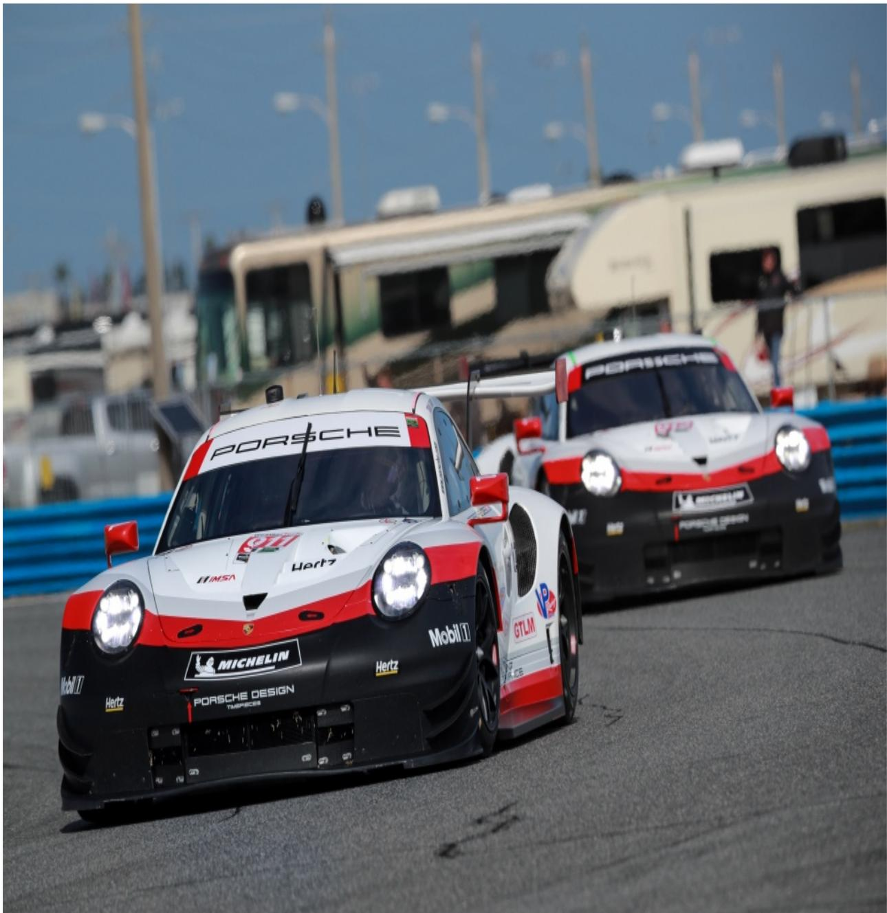
Neben konsequentem Leichtbau setzten die Konstrukteure in Weissach beim 911 RSR auf die Anordnung des hochmodernen frei saugenden Sechszylinder-Boxermotors vor der Hinterachse. Das vier Liter große, äußerst leichte Aggregat verfügt über Benzin-Direkteinspritzung sowie einen starren Ventiltrieb und zeichnet sich durch hervorragende Effizienz aus. Seine Rennpremiere feierte der 911 RSR im Januar 2017 beim 24-Stunden-Rennen in Daytona.
