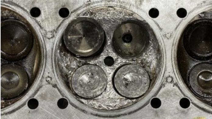
Oft reissen die Ventile, auch Einlassventile wie in diesem Fall ab, und kolossale Motorschäden entstehen. Durch ausgeschlagene Ventilfehrungen kommt es zu Biegewechselbeanspruchungen und Brüchen des Ventils am Übergang vom Schaft zum Ventilteller. Dadurch werden Kolben und Zylinder, in diesem Fall der ganze Motor, vollkommen zerstört.
