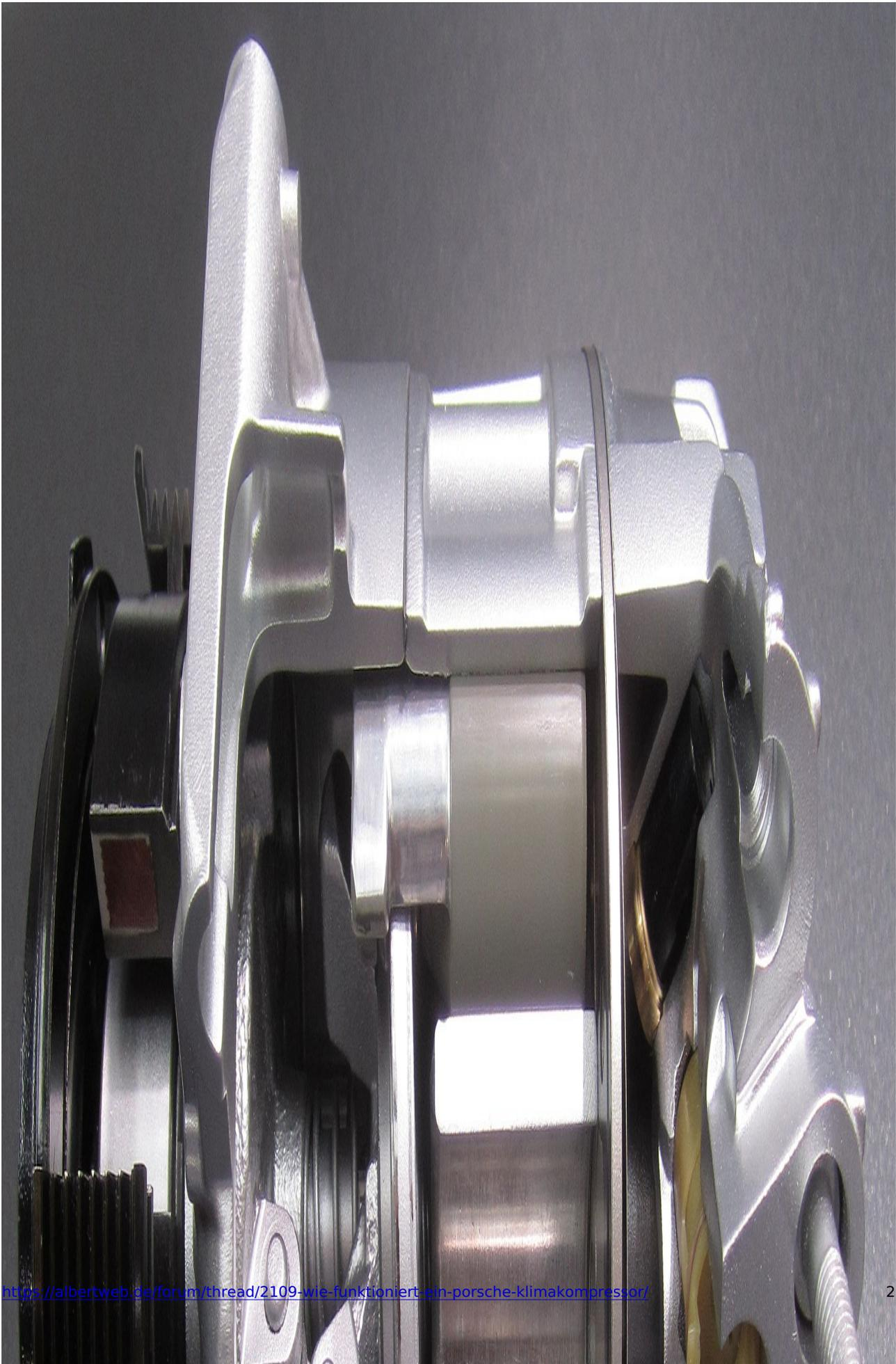
Auf dem Bild ist sehr gut die schräg zur Achse eingebaute Taumelscheibe, der eigentliche Antrieb der Kolben, in unserem Porsche Klima-Kompressor erkennbar.
