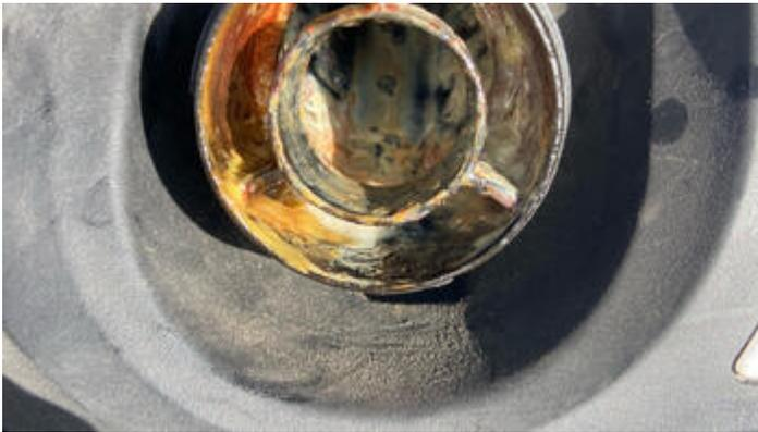
Der Ölschlamm, der oft im Ölfilter-Deckel unserer Porsche auftritt, ist eine Folge der [#Blow #by #Gase](#) die auch in einem [#Porsche #Verbrennungsmotor](#) entstehen.
