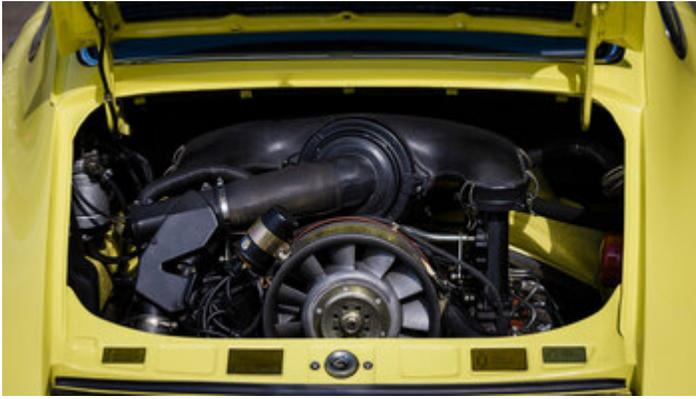
Der 2,7-Liter-Sechszylinder-Boxer mit Benzineinspritzung leistet beim 911 Carrera RS 2.7 starke 210 PS bei 6300 U/min und entwickelt 255 Nm bei 5.100 U/min. Das reicht in der Sport-Version für eine Beschleunigung von 0 auf 100 km/h in 5,8 Sekunden. Damit durchbricht der 911 Carrera RS 2.7 als erster Serienwagen die Sechsen-Sekunden-Marke der deutschen Fachzeitschrift *auto, motor und sport*.
