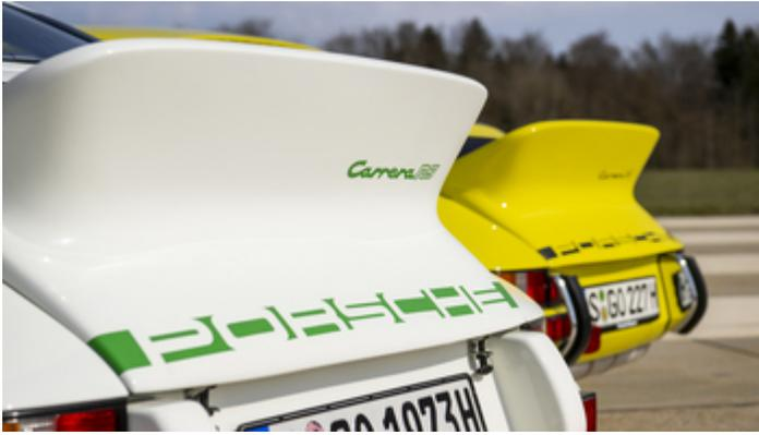
Der neue „Entenbürzel“ drückt mit seiner Erhebung den 911 Carrera RS 2.7 bei schneller Fahrt Richtung Straße und versorgt den Heckmotor mit zusätzlicher Kühlluft. Dabei wird der Effekt ohne Luftwiderstandserhöhung erzielt – im Gegenteil: Die Höchstgeschwindigkeit wächst um 4,5 km/h. „Bei Tests stellten wir fest, dass wir mit einem höheren Spoiler die Höchstgeschwindigkeit erhöhen konnten, weil der
