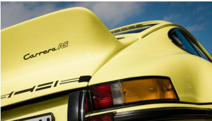
Bei der Karosserie geht es um Gewichtsreduzierung: Mit Dünoblechen, dünnen Scheiben, Kunststoffteilen und dem Verzicht auf Dämmung muss das Fahrzeuggesamtgewicht der Rennwagen auf unter 900 Kilogramm sinken, um das neue Modell homologisieren zu können. Gleichzeitig soll die Aerodynamik besser werden: Bei hohen Geschwindigkeiten gilt es, den Auftrieb an Vorder- und Hinterachse zu
