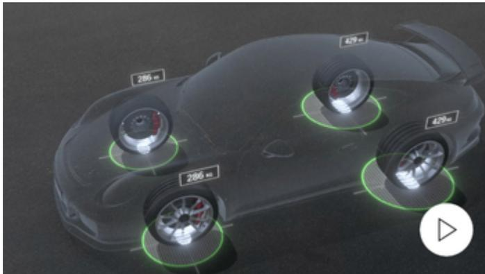
Als Radlasten in einem Automobil bezeichnet man die Kraft, die senkrecht zur Fahrbahn gemessen, auf die Räder und Reifen einwirken.
